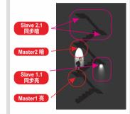
在后楼梯应用中,我们將主管LED tube初始亮度設置為30%或者全滅,燈管地址,直接在撥碼開關上做好設置;當有人進入到感應區域時,主管接收到感應信號,亮度立即會調至全亮,僕管收到主管發出的信號,立即同步全亮。當人經過後,設定一段時間延時,主管變為30%或者全滅,僕管同步30%或者全滅。简单要求可以直接在拨码开关上实现设置,操作比较简单方便。
