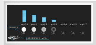
一、車輛進入地下車庫,雷達感應到A信號, 亮度100%,同時發出無線信號(B信號),通知附近 相鄰的燈依次亮起60%,40%,20%亮度
