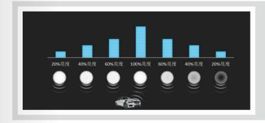
二、車輛駛入,雷達感應到的燈依次亮起 100%亮度,之前的節點延時後,根據遠近輸出 60%,40%,20%亮度。(導航照明,波浪照明)
