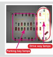
將主管LED tube初始亮 延時,主管變為30%或者全 滅,僕管同步30%或者全滅。
